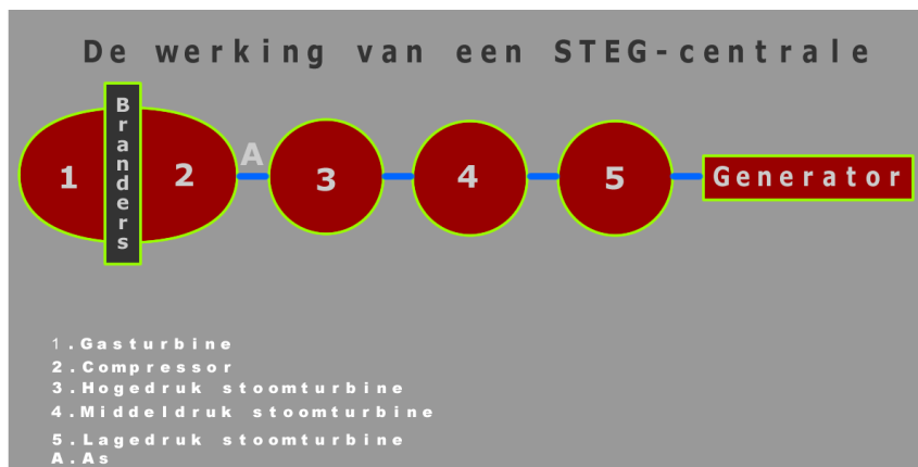
Figuur 17: Werking van een STEG-centrale
