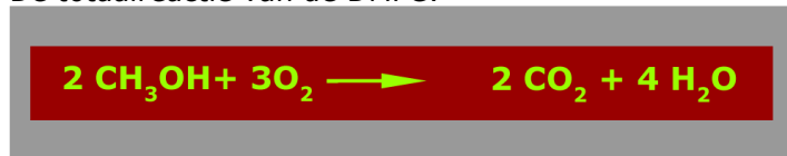
Figuur 22: de totaalreactie van de DMFC
